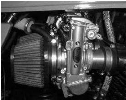
Vergaser Mikuni TMR36, mit rollengelagerten Flachschiebern, der ultimative Tuningvergasern, bringt sofort mindestens 5% mehr Leistung, Abstimmung sehr einfach
